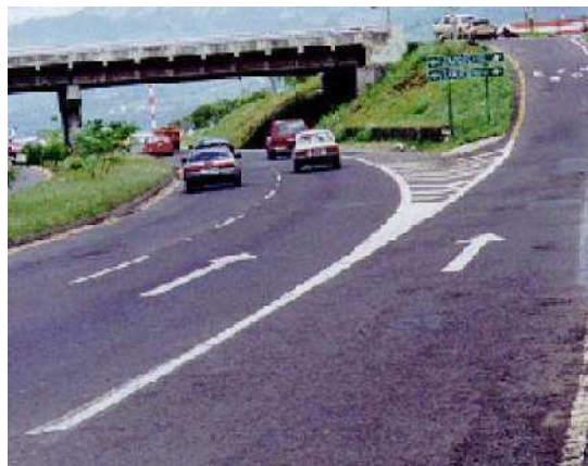
Fotografía 4.7 Extremo de isla con demarcación gradualmente ensanchada.
